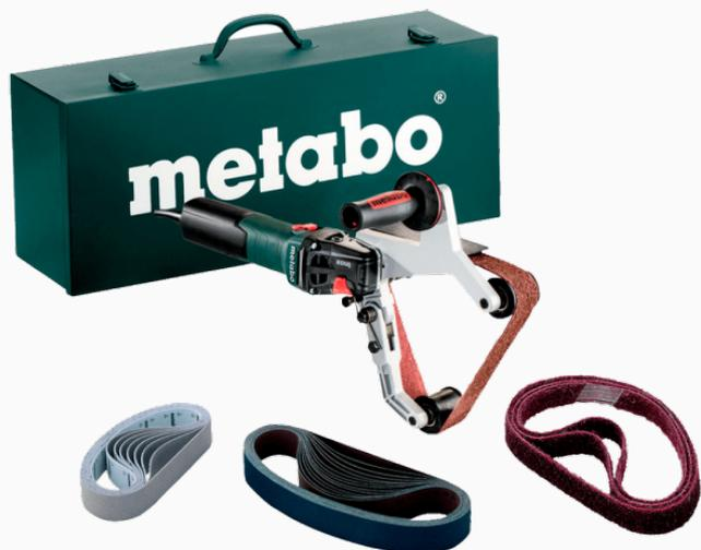
Lijadora para tubos de hasta 180 mm o superficies planas. 1550 w de potencia. Cuenta con motor Marathon, con protección contra polvo y carbones auto desconectables para mayor vida útil. Velocidad variable, ideal para inoxidable. Cuenta con arranque electrónico y protección contra desconexión involuntaria.
