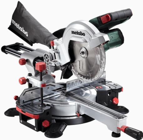
Ingletadora (con función de tracción) a batería 18 V. Hoja de sierra Ø 216 x 30 mm. Capacidad de corte 90°/90°: 305 x 65 mm. Capacidad de corte 45°/45°: 205 x 36 mm. Aspiración de viruta. Laser para indicar línea de corte. Luz LED de trabajo. Pinza para fijación de pieza.
