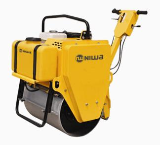
Rodillo compactador simple Niwa Roadway Motor HONDA GX160 5,5 HP. Peso: 283 kg. Conducción: Manejo hidráulico estático. Ancho rodillo del. 600 mm. Diam. 450 mm. Frecuencia 70 Hz. Fuerza Centrifuga Max 15 kN. Vel. de desplazamiento:0 - 2,8 km/h.
