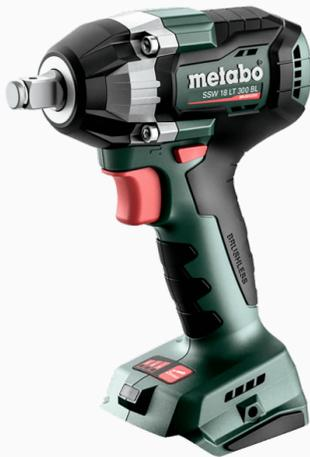
Llave de impacto de batería con cuadrante de ½" y 300 Nm. Con motor Brushless de Metabo para un avance rápido del trabajo y máxima eficiencia en cada aplicación. Tres niveles de revoluciones/par de apriete para múltiples ámbitos de aplicación. Lámpara de trabajo integrada para una iluminación óptima del lugar de trabajo. Con una robusta carcasa del engranaje de fundición a presión de aluminio para una óptima evacuación del calor y durabilidad. Incluye maletín.
