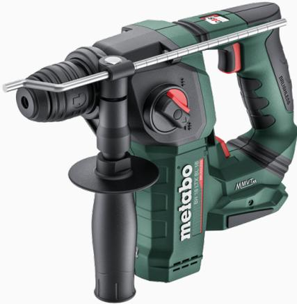
Martillo a batería 18 V compacto. Rendimiento profesional (1,3 Joule), tecnología Brushless, electrónica constante, para trabajos de bajo esfuerzo (por ejemplo, aplicaciones por encima de la cabeza). Con embrague electrónico para un trabajo seguro incluso con el manejo con una sola mano. Mango antivibratorio para trabajo continuo. 16 mm máximo de perforación en hormigón. Metabox 145 L
