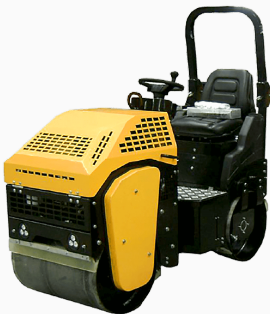
Rodillo compactador Niwa Roadway Hombre a bordo.
