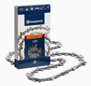
Una cadena con diente cincel y alto rendimiento de paso 3/8" y calibre 1,5 mm, diseñada para motosierras forestales profesionales de uso intensivo. Esta cadena, fabricada exclusivamente por Husqvarna®, te ofrece el máximo rendimiento de tu motosierra. Gracias a su extraordinaria durabilidad y eficiencia de corte, su afilado de larga duración y su baja elasticidad, obtendrás mejores resultados con menos mantenimiento y costos.
