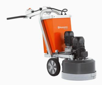
La PG 530 es una pulidora semi profesional monofásica de 530 mm de diámetro y dos motores, de alta capacidad para propósitos residenciales y comercial liviano. Sistema planetario de tres cabezales, con control de velocidad e inversión de giro. Excelente para la remoción, preparación, reparación y pulido a espejo de pisos de hormigón HiPERFLOOR® de Husqvarna. Indicada para superficies mayores a 500 m2. Para un resultado optimo se recomienda el uso con la aspiradora Husqvarna DC 3300.
