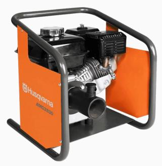
La infalible unidad motriz Husqvarna MG3200 para vibradores de inmersión mecánicos AA y AZ, es la indicada para un trabajo eficiente. Su motor Honda GX 160 con monturas de goma, y ofrece potencia fiable toda la jornada de trabajo en cualquier condición, y su mantenimiento resulta fácil cuando es necesario. Un acoplamiento tipo Dynapac, resistente y de apertura rápida, permite transmitir potencia al flexible fácilmente.
