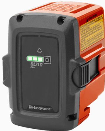
Batería de Li-Ion de 36 V, con una potencia de 75.6 W/h y una capacidad 2 Ah. El modelo BLi 10 fue diseñado para lograr un alto rendimiento en los equipos de la Serie 100 (Excepto en motosierras) y un peso reducido 0,81 Kg y una vida útil de 400 ciclos. También presenta un indicador LED para identificar su estado. Compatible con los cargadores QC 80 y QC 330. (No esta incluido en los equipos)
