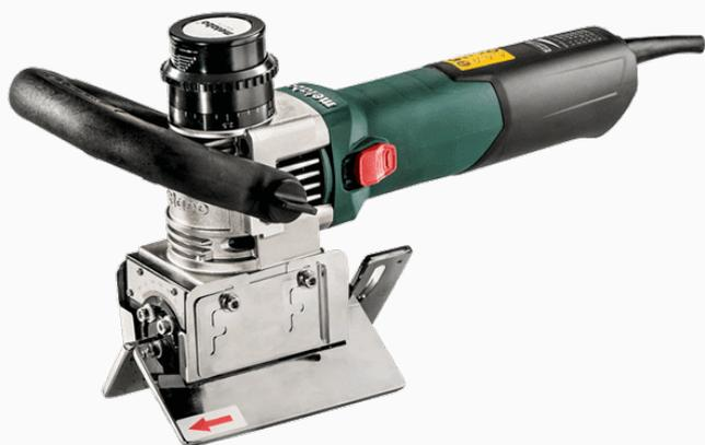
Potente biseladora, para preparar costuras de soldadura. Realiza ángulos de bisel de 0-90°, para biseles de hasta 10 mm de altura. Placas guías de metal para realizar biselado controlado.
